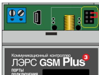
Рисунок 5.1 – Установка переключки для обновления ПО
